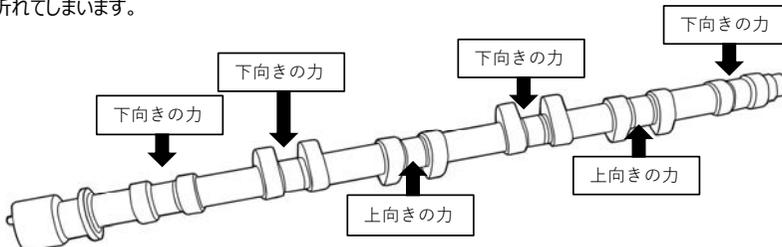
カムシャフトを組み付ける際は、できるだけヘッド面に対してカムを水平に均等に少しずつ締めていってください。
