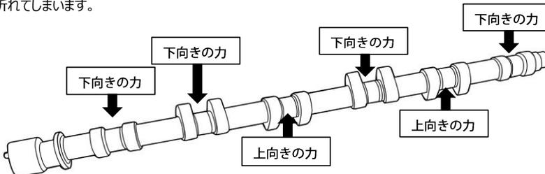
カムシャフトを組み付ける際は、できるだけヘッド面に対してカムを水平に均等に少しづつ締めていってください。
