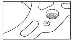
② Φ5程度のピンポンチを用いて、純正オリフィスを6ミリ打ち込む。
