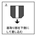
② ピンポンチを用いてΦ1.5のオリフィスを打ち込む。
