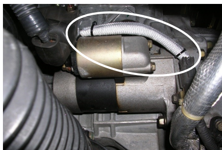
車体左側のスターター配線
